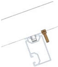
Vor der Modulmontage sind über der oberen oder unteren Schienenlage die Modulabrutschsicherungen an den Rahmenbohrungen zu montieren. Zur Erleichterung der Modulmontage wird der Einsatz der Abrutschsicherung an allen Modulen empfohlen.
