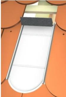
Position des Blechziegels ermitteln. Ziegel durch Biberschwanz-Blech ersetzen – die Blechkanten befinden sich unter den Nachbarziegeln – und mit Schrauben fixieren danach Schaumstoffkeil aufkleben.
