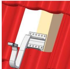
Dachhaken einlegen, sodass der Bügel im Wellental des Dachziegels liegt.
