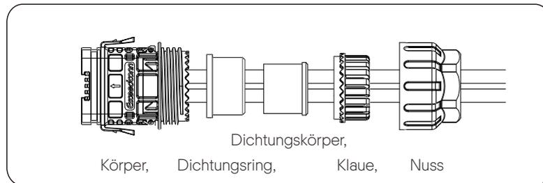
e) Setzen Sie die Klemme entsprechend des Etiketts in das Gehäuse ein. Schieben Sie das Gehäuse mit Klemmeinsatz in den Körper. Es ertönt ein leises „Klick“-Geräusch, das anzeigt, dass die Verbindung hergestellt ist.
