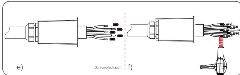
➤ Schritt 2: Schließen Sie das AC-Kabel an den Wechselrichter an
