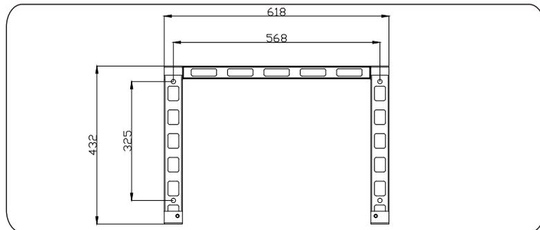
c) Verwenden Sie die Halterung als Schablone, um die Position der Bohrlöcher an der Wand mit einer Wasserwaage und einem Marker zu markieren.
