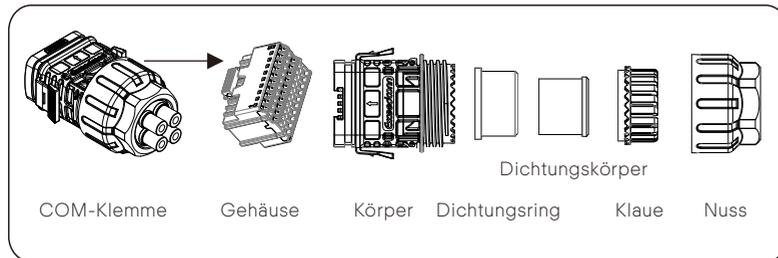
b) Wählen Sie einen Leiter von 0,5-0,75 mm<sup>2</sup> und verwenden Sie eine Abisolierzange, um 12–14 mm Isolationsschicht des Kabelendes abzuisolieren. Führen Sie die isolierte Kabelendklemme in das Kabelende ein. (ENY0512 Klemme für 0,5 mm<sup>2</sup>/22 AWG-Leiter; ENY7512 Klemme für 0,75 mm<sup>2</sup>/20 AWG-Leiter)
