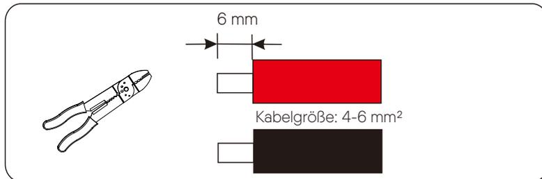
d) Ziehen Sie den abisolierten Abschnitt fest und stecken Sie ihn in die PV-Stifte. Verwenden Sie Klemmklemmen, um ihn so festzuklemmen, dass der abisolierte Abschnitt des PV-Kabels in festem Kontakt mit den PV-Stiften
