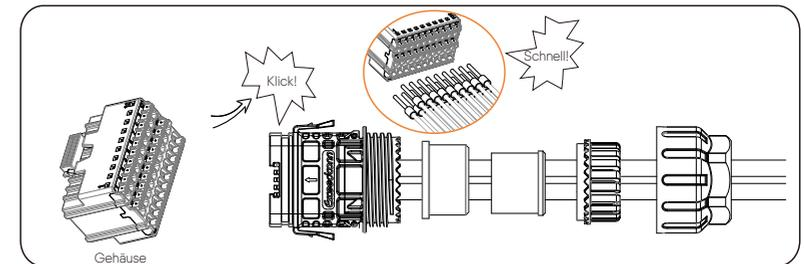
f) Drücken Sie den Dichtungskörper in den Dichtungsring, drücken Sie dann die Klaue herab.
