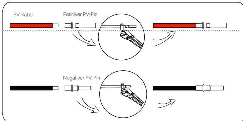
e) Führen Sie das PV-Kabel durch den Befestigungskopf und den Stecker (männlich und weiblich) und drücken Sie den männlichen oder weiblichen Stecker auf das Kabel. Sie hören ein „Klicken“, was anzeigt, dass die Verbindung hergestellt ist. Ziehen Sie dann den Befestigungskopf fest.
