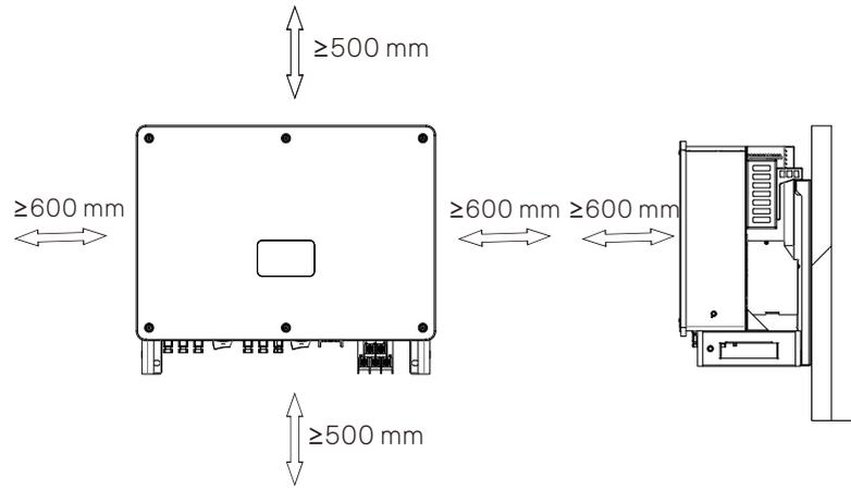
Reservieren Sie für die Installation mehrerer Wechselrichter mindestens 1200 mm Platz zwischen jedem linken und rechten Wechselrichter und mindestens 500 mm zwischen jedem oberen und unteren Wechselrichter.
