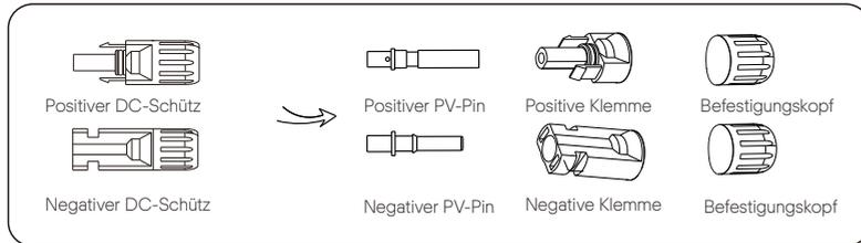
c) Schalten Sie den DC-Schalter aus und bereiten Sie ein 4–6 mm<sup>2</sup> PV-Kabel vor. Verwenden Sie eine Abisolierzange, um 6 mm Isolationsschicht des PV-Kabelendes abzuisolieren.
