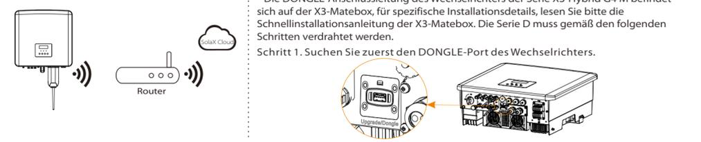
Schritt 2. Stecken Sie Pocket WiFi in den DONGLE-Anschluss. Please check the Pocket WiFi user manual/Pocket LAN user manual/4G user manual for more details.
