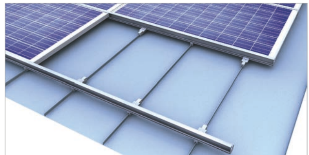
Einlegesystem: Quermontage Stehfalz
