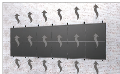
Sehr gute Hinterlüftung der Module
