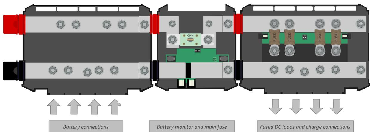
Zusammenschaltete Lynx-Module: Lynx Power In, Lynx Shunt VE.Can und Lynx Distributor
