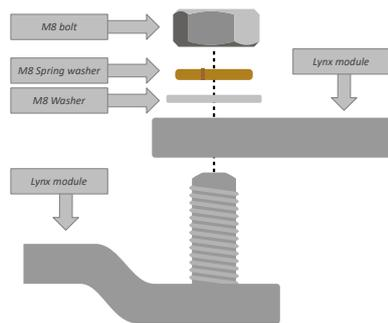
Korrekte Platzierung von M8-Unterlegscheibe, Federscheibe und Mutter.
