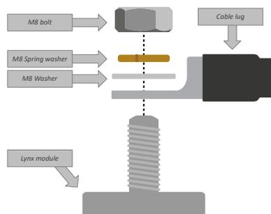
Korrekte Platzierung von M8-Kabelschuh, Unterlegscheibe, Federscheibe und Mutter
