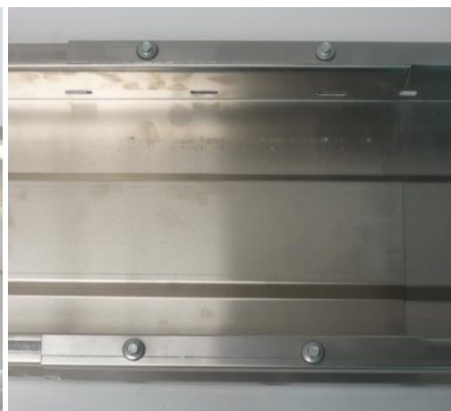
Abbildung 13: Verlängerung und Verschraubung Grundschiene 230 - 90
